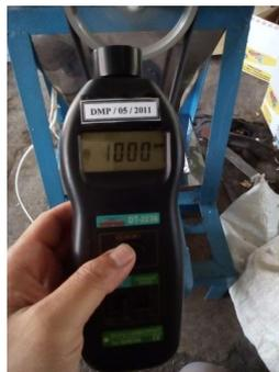
Gambar 4. Pengukuran rpm pada Pulley atas menggunakan Tachometer
