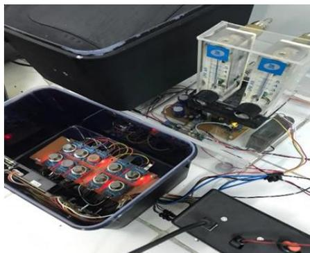
**Gambar 1.** Alat ukur aroma dan volatile gas yang digunakan
