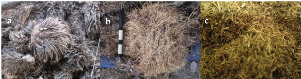
Gambar 1. Serabut Tandan Kosong Kelapa Sawit Sebelum dan Sesudah di- grinding , Keterangan : a) bonggol TKKS sebelum dicacah, b) serabut TKKS sesudah dicacah, c) serabut TKKS sesudah di- grinding
